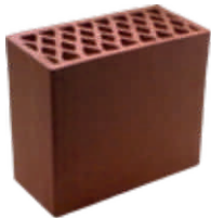
“Теплый” кирпич 3,6 НФ М-175 теплопроводность-0,22
